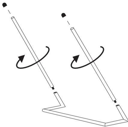
Gewinkeltes Trägerrohr so auf den Verpackungskarton legen, dass die Rohrenden mit den Innengewinden nach oben zeigen.
