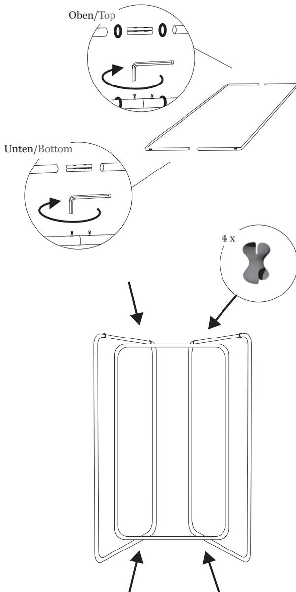
Die Rahmenteile gleicher Grösse mittels Rohrverbinder zusammenschrauben. Bei den beiden grösseren Rahmenteile können Sie oben vorgängig je 2 Gummiringe auf das Rohr schieben (diese Ringe dienen als Kleiderbügelstopper).
