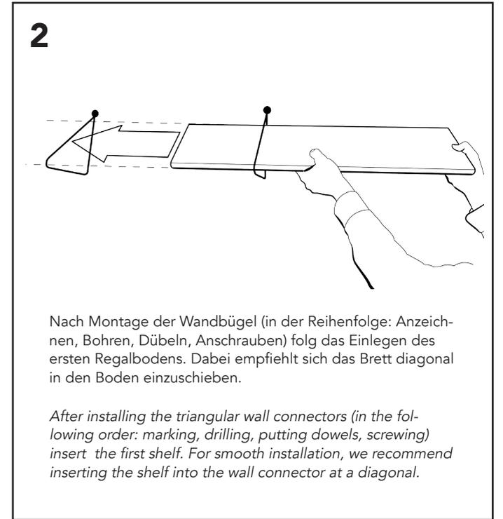
Nach Montage der Wandbügel (in der Reihenfolge: Anzeichnen, Bohren, Dübeln, Anschrauben) folg das Einlegen des ersten Regalbodens. Dabei empfiehlt sich das Brett diagonal in den Boden einzuschieben.
