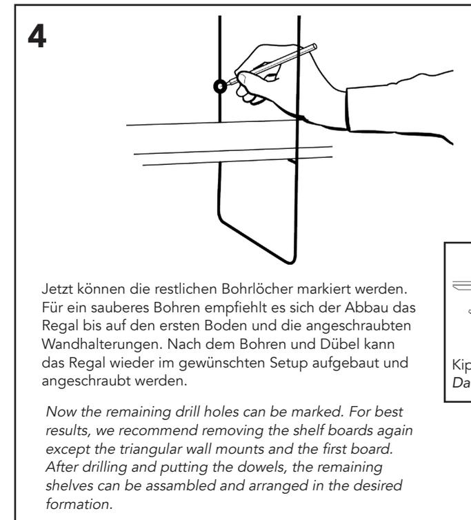
Jetzt können die restlichen Bohrlöcher markiert werden. Für ein sauberes Bohren empfiehlt es sich der Abbau das Regal bis auf den ersten Boden und die angeschraubten Wandhalterungen. Nach dem Bohren und Dübel kann das Regal wieder im gewünschten Setup aufgebaut und angeschraubt werden.
