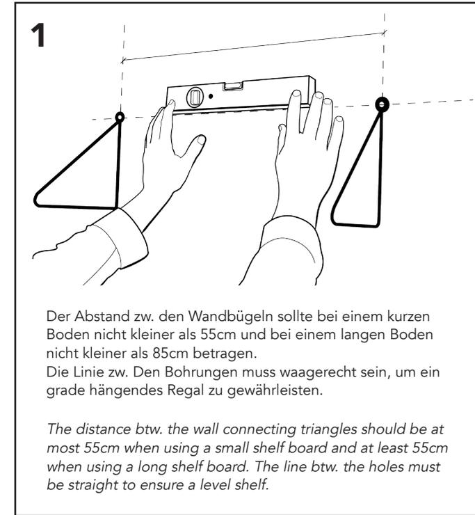
Der Abstand zw. den Wandbügeln sollte bei einem kurzen Boden nicht kleiner als 55cm und bei einem langen Boden nicht kleiner als 85cm betragen.
