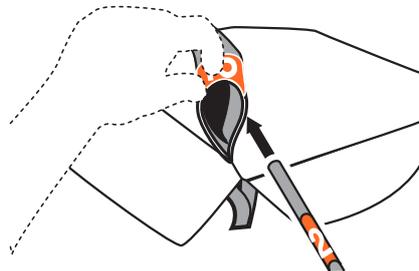
5. Schieben Sie das graue Gestänge durch den grauen Textiltunnel (2) der Plane.
