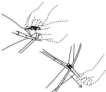
7. Wickeln Sie die Klettänder fest um das Gestänge und sichern Sie diese indem Sie das Band durch den zweiten Teil der Plastiksnalle ziehen.
