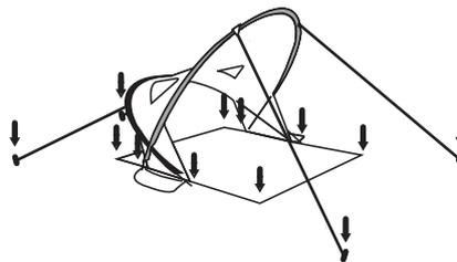
8. Sichern Sie den Sonnenschutz indem Sie die Heringe durch die Metallringe der Plane in den Boden schieben und ziehen Sie die 3 Kordeln mit Spannung fest.
