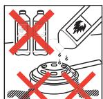
Der Brennspritzeneinsatz in Kombination mit einem Pastenbrenner darf nur mit Brennspirit betrieben werden. Bei Verwendung von falschen Brennstoffen wie Benzin besteht Verbrennungs- und Explosionsgefahr.
