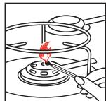
Brennspriteinsatz einlegen (Löcher nach oben) und Brennsprit bis zum Lochsieb (max. 90 ml) mittels Messbecher einfüllen. Nicht direkt mit der Flasche auffüllen (Ausschüttungsgefahr).
