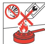
Den Pastenbrenner nie in brennendem oder heißem Zustand nachfüllen. Den Brenner öffnen und den Brennspritzeneinsatz nur in abgekühltem Zustand wieder befüllen.
