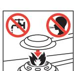
Flamme darf nur mit Löschkappe gelöscht werden. Nicht auspusten oder mit Wasser löschen!
