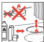
Den Pastenbrenner erst anzünden, wenn der Drehschieber aufgesetzt ist, sich Pastenbrenner mit dem Brennspritzeneinsatz im Rechaud befinden und wenn alle Gegenstände in unmittelbarer Nähe einen sicheren Abstand zum Gerät halten.
