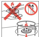
Der Pastenbrenner darf erst angezündet werden, wenn sich das Rechaud am dafür vorgesehenen Ort, auf einer flachen Ablage (Tisch), befindet. Der Brenner darf nicht in der Hand angezündet werden.
