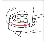
Brenner aus dem Rechaud nehmen, Löschkappe abnehmen, Brenner öffnen (Bajonettschluss).
