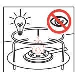
Bei Tageslicht oder hell beleuchteten Räumen ist die brennende Flamme schlecht sichtbar. Bitte Vorsicht, da sonst Verbrennungsgefahr bestehen kann. Die Flamme reagiert nicht unmittelbar nach dem Verstellen der Luftlöcher. Haben Sie Geduld, die Reaktionszeit nimmt ca. 30-60 Sekunden in Anspruch.
