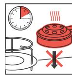
Das Gerät abkühlen lassen, bevor man den Brenner herausnimmt. Den heißen Brenner keinesfalls auf einer hitzeempfindlichen Unterlage abstellen, bevor er nicht total abgekühlt ist.
